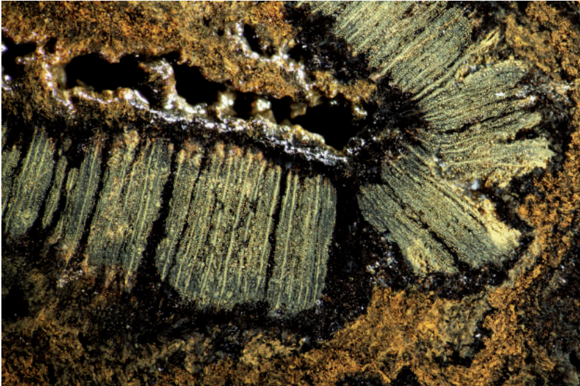
Abb. 25: Pilzinfektion rund um parallel zur Stammachse verlaufende Röhren (Löcher in der Mitte), Der Pilz breitet sich entlang der Holzstrahlen aus (hellgelbe Strukturen); Auflicht x 40, S. Nickel/W. Follmer.
