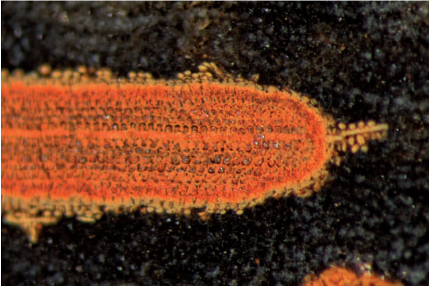
Abb. 22: Unerklärlicher geradliniger Pilzfraß entlang eines Holzstrahls (rote Struktur); die infizierte Holzstrahlspitze ist abgebrochen; Das Holz ist zu einer schwarzen Masse zersetzt; auch hier waren möglicherweise Holz zersetzende Bakterien aktiv; Auflicht x 100, S. Nickel/ W. Follmer.
