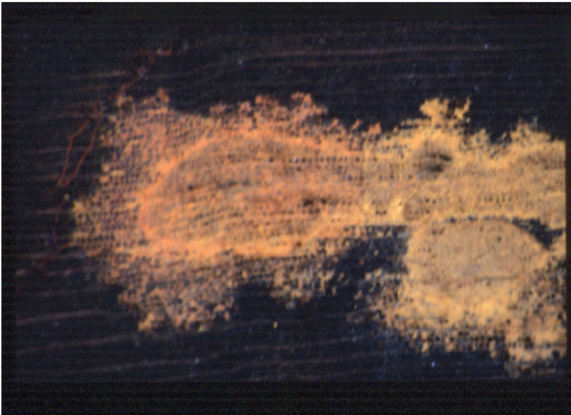
Abb. 21: Infiziertes Tracheidengewebe in einem weitgehend zu einer schwarzen Masse zersetzten Holz; die Anlage der Holzstrahlen ist nur noch schemenhaft erkennbar; möglicherweise ist hier Zellulose und Lignin zersetzende Fermentation durch Bakterien dokumentiert; vom Pilz infiziertes, chitinhaltiges Holzgewebe konnte durch Zellulose zersetzende Bakterien mangels Chitinase nicht zersetzt werden; Auflicht x 40, S. Nickel/W. Follmer.
