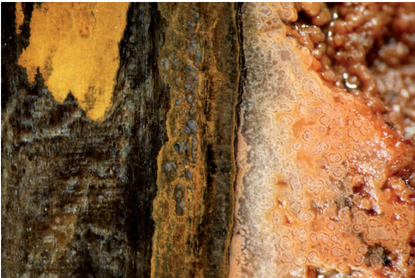
Abb. 32: Längsschliff: Holzsubstanz mit Pilzfraß (links, gelb) und Hyphenstrang (Mitte); möglicherweise eine zersetzte Fruchtkörperkruste mit Sphärolith- und Quarzkristallaggregaten (rechts). Auflichtaufnahme x 10, S. Nickel.
