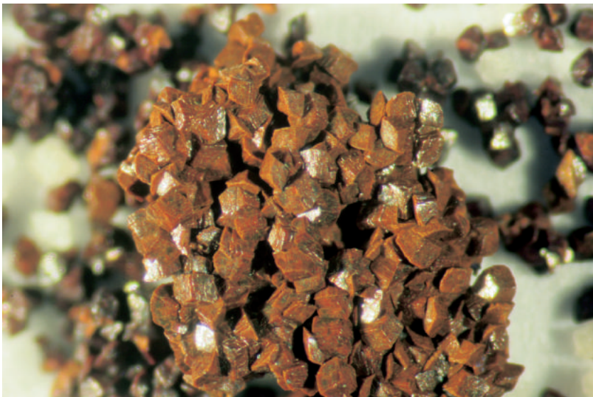
Abb. 1. Massenkristallinat von ehemaligen Sideritkristallen. Die Kristalle sind grossenteils miteinander verwachsen. Der begleitende Lehm wurde durch Ultraschallbehandlung entfernt. Herkunft: Steinbruch im Kleinen Lautertal bei Ulm. Die Bildbreite entspricht 3,8 mm.
