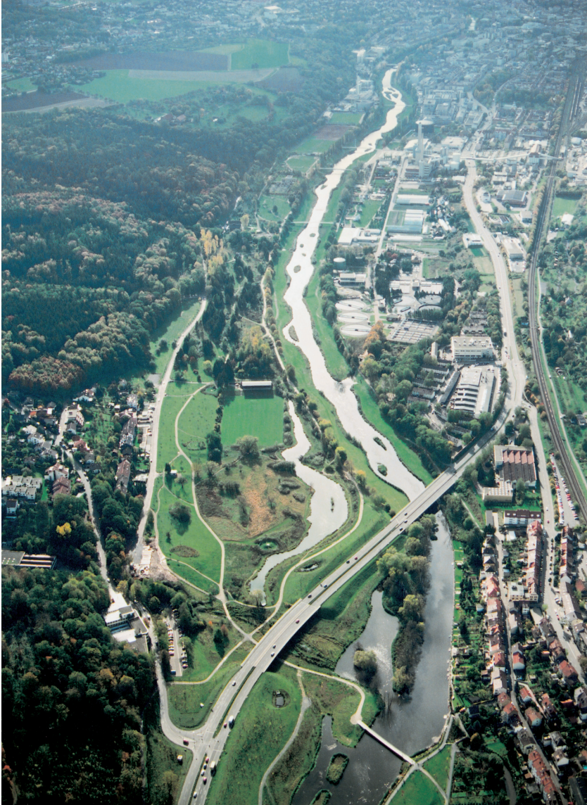
Abb. 12: Oben die Kernstadt von Pforzheim; vorn rechts Teilort Eutingen. Ein aufschüttender Fluss hat ein breites, verzweigtes Bett. Hier reichte der Platz für die Landesgartenschau 1992. Die Planer haben den geraden Lauf durch einen bewegten ersetzt (Luftbild STEIBMETZ ca. 1994).
