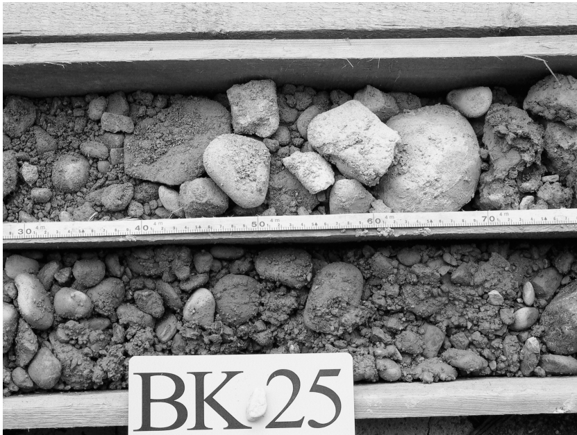
Abb. 5. Foto des Bohrkerns aus BK 25 zwischen 4,3 bis 4,8 m (oben) und 5,3 bis 5,8 m (unten). Der Geschiebemergel befindet sich im oberen Fach rechts.
