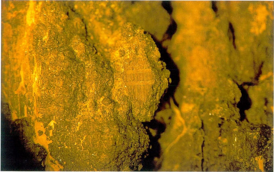
Abb. 23: Rautenartig zerfallendes Holz mit Pustelbildung an der Oberfläche, Tracheidenzellgewebe zeigt im Tangentialbruch deutlich Tracheidenreihen und Holzstrahlen; Auflicht.
