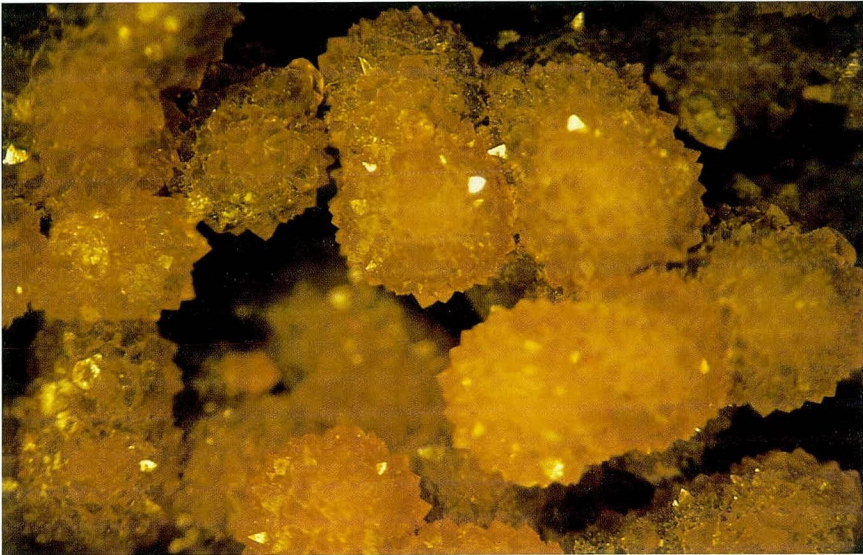
Abb. 15: Durch Eisen-Hydroxid gelb gefärbte Quarzrosetten in einem Hohlraum aufgewachsen in 2. Generation auf einem xenomorphen und idiomorphen Quarzkristallrasen; Rosettendurchmesser 1 – 1,5 mm; Auflicht.
