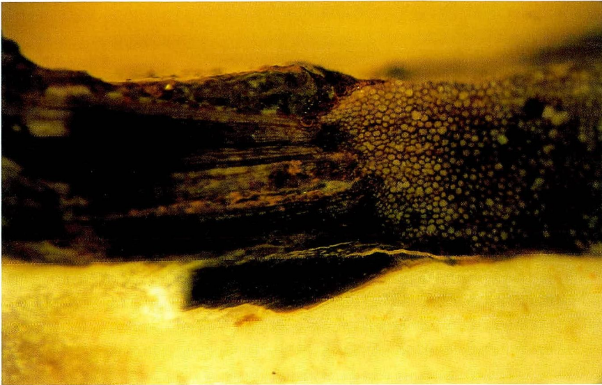
Abb. 26: Holzsplitter mit Markgewebe, Primärholz und Sekundärholz im Querbruch; Auflicht.
