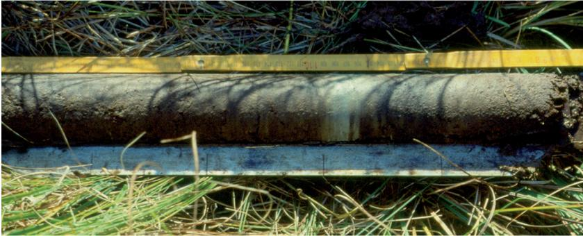
**Abb. 3:** Für die Probengewinnung wurde am häufigsten ein russischer Torfbohrer verwendet. Dieser liefert 50 Zentimeter lange, halbzylinderförmige Bohrkern wie hier im Breilried (Stadt Haigerloch, Ortsteil Trillfingen) am 24.09.1991.
