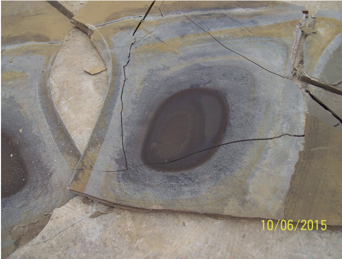
Abb. 1: Stark bituminöse Plattenkalke innerhalb der Schicht G. Die Oxidation erfolgt von den Klüften aus (Foto: A. ILG).
